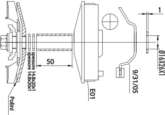
Regolazione con cinghia usurata sp. 19 - Adjustment with worn th. 19 belt - régulation avec courroie préte à usure épaisseur 19 - Regulación con correa con signos de desgaste esp. 19 - Regelung mit abgenutzten Riemen Dicke 19
